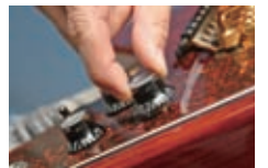
▲フロント・ボリュームを引くと、フロント・ピックアップのみタップされる仕組みを採用
